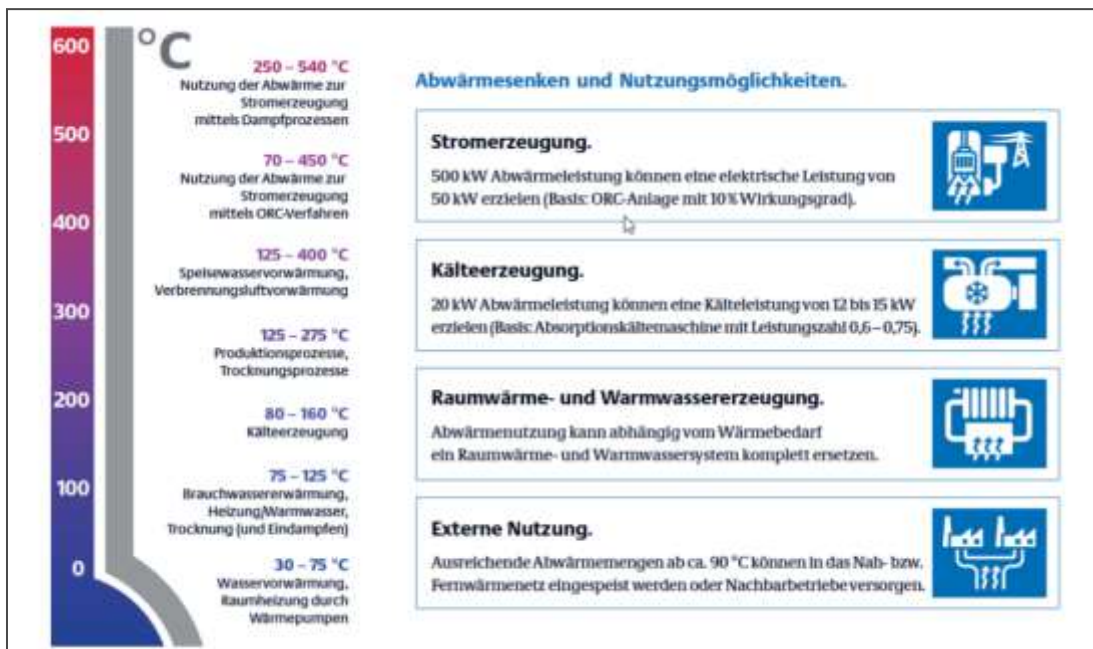
Abbildung 4-8: Nutzung von industrieller und gewerblicher Abwärme in Abhängigkeit vom Temperaturniveau (Erfolgreiche Abwärmenutzung im Unternehmen. - Energieeffizientpotenziale erkennen und erschließen, 2015, S. 4)
